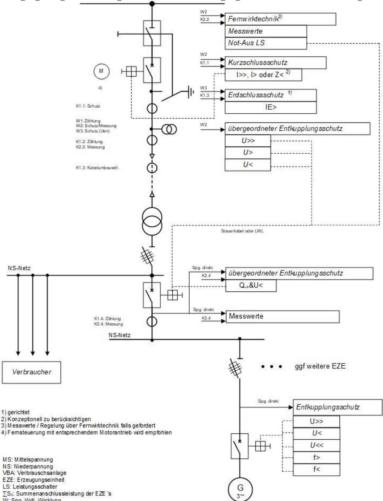
**Bild 9-Einspeisung** – Beispiel für eine an das Mittelspannungsnetz angeschlossene Kundenanlage mit Erzeugungsanlage mit Lasttrennschalter und einer Erzeugungseinheit ohne Inselbetriebsmöglichkeit
