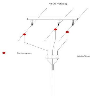
**Bild 7–Einspeisung** - Beispiel für eine Übergabestation mit einer mittelspannungsseitigen Messung und einem Netzbetreiber-Anschluss als Abzweig-Muffe am MS-Kabel oder Kabelaufführung am Mast der MS-Freileitung Kabelfeld / Feld mit Leistungsschalter (KLS)
