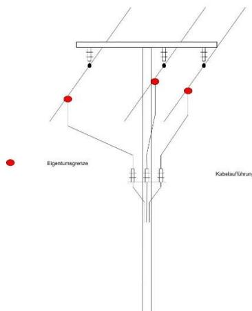
**Bild 8-Einspeisung** – Beispiel für eine an das Mittelspannungsnetz angeschlossene Kundenanlage mit Erzeugungsanlage mit Leistungsschalter und einer Erzeugungseinheit ohne Inselbetriebsmöglichkeit
