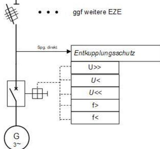
**Bild 12 Einspeisung** – Beispiel einer an das Mittelspannungsnetz angeschlossene Kundenanlage mit Erzeugungsanlage mit einer Erzeugungseinheit und Inselbetriebsmöglichkeit über niederspannungsseitigen Kuppelschalter
