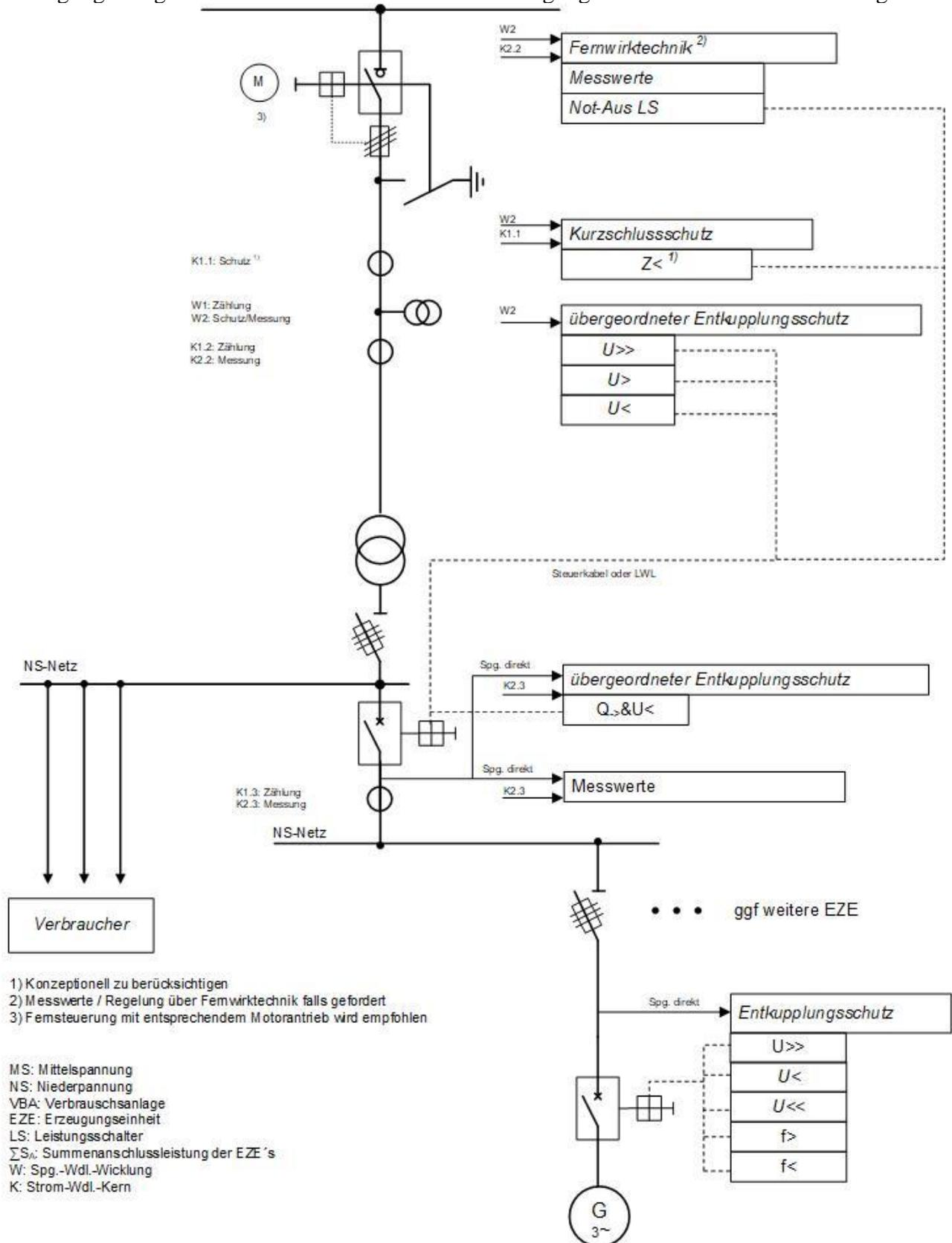
**Bild 11 Einspeisung** – Beispiel einer an das Mittelspannungsnetz angeschlossene Erzeugungsanlage mit Lasttrennschalter und Erzeugungseinheit ohne Inselbetriebsmöglichkeit
