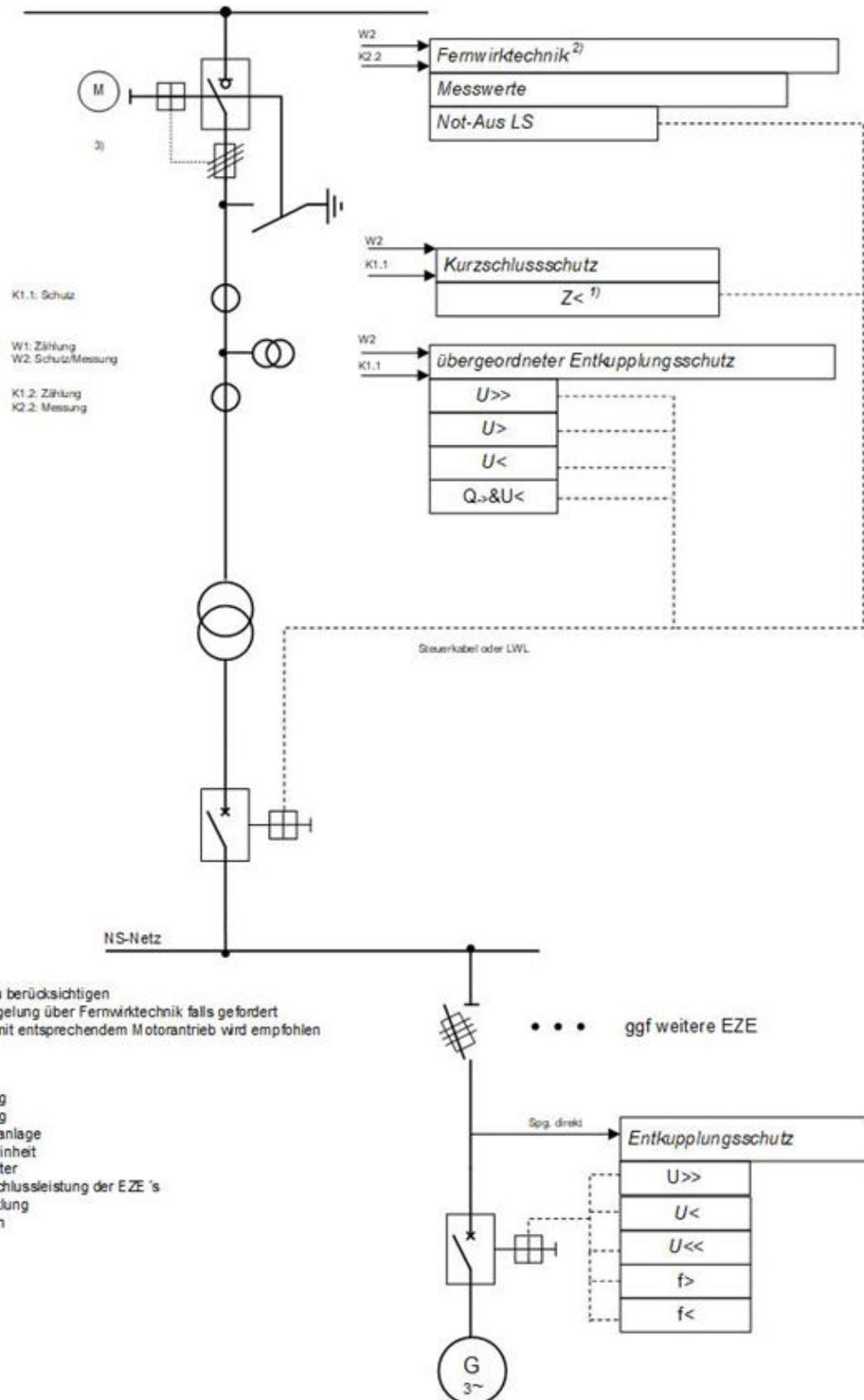
**Bild 12 Einspeisung** – Beispiel einer an das Mittelspannungsnetz angeschlossene Kundenanlage mit Erzeugungsanlage mit einer Erzeugungseinheit und Inselbetriebsmöglichkeit über niederspannungsseitigen Kuppelschalter
