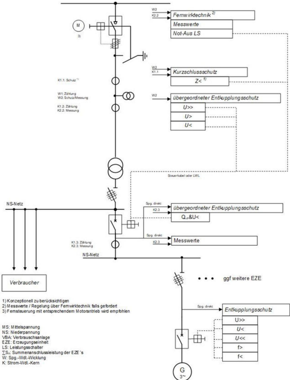
**Bild 10 Einspeisung** – Beispiel einer an das Mittelspannungsnetz angeschlossene Erzeugungsanlagen mit Leistungsschalter und Erzeugungseinheit ohne Inselbetriebsmöglichkeit
