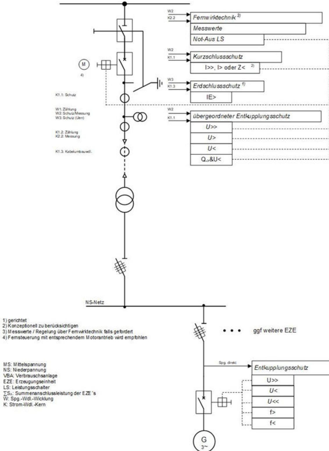
**Bild 11 Einspeisung** – Beispiel einer an das Mittelspannungsnetz angeschlossene Erzeugungsanlage mit Lasttrennschalter und Erzeugungseinheit ohne Inselbetriebsmöglichkeit
