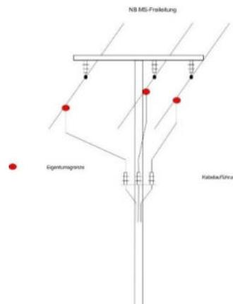
**Bild 8-Einspeisung** – Beispiel für eine an das Mittelspannungsnetz angeschlossene Kundenanlage mit Erzeugungsanlage mit Leistungsschalter und einer Erzeugungseinheit ohne Inselbetriebsmöglichkeit
