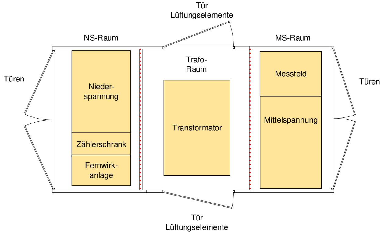
Schutzgrad mind. IP 23-D für Be- und Entlüftungen des Gebäudes sowie für Türen/Luken
