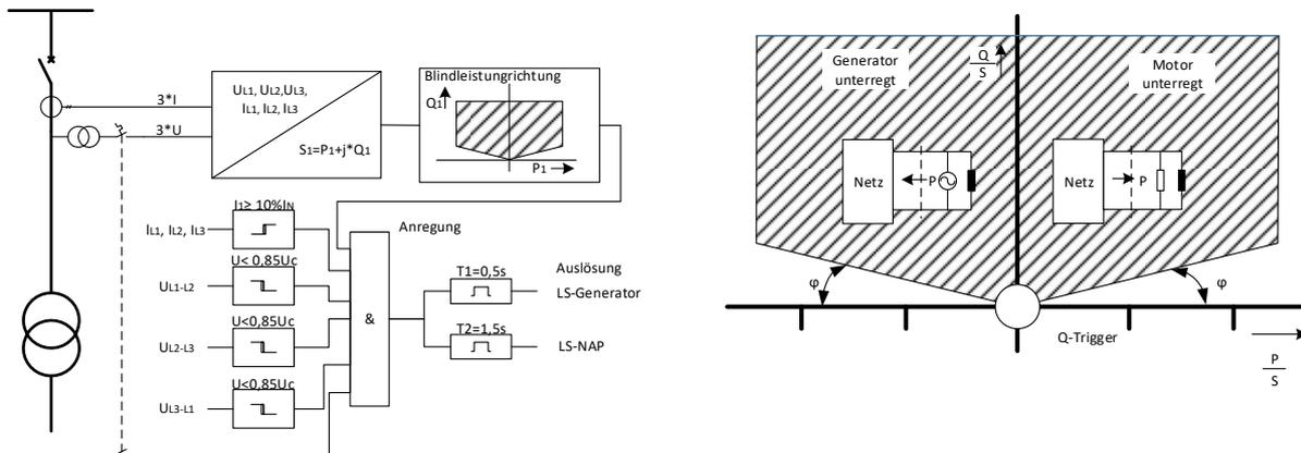
Die Anregebedingungen sind wie in der 1. Variante logisch-„und“-verknüpft und müssen ebenfalls gleichzeitig über die Dauer der Kommandozeiten ( $t_1$ ,  $t_2$ ) am Schutzrelais anstehen, ehe es zur Auslösung der Leistungsschalter kommt. Zusätzlich wird in dieser Variante, bei Messspannungsausfall durch den Sicherungsautomat der Spannungswandler, die Anregung des Q→&U<-Schutzes blockiert.
