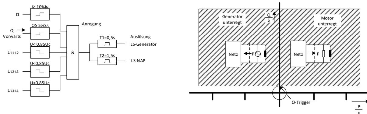
Sind die Anregebedingungen der Mindeststromfreigabe,  $I \geq 10 \%$  und der Blindleistungsschwelle,  $Q \rightarrow \geq 5 \%$  und der Unterspannungen aller drei verketteten Leiterspannungen  $U < 0,85$  erfüllt, erfolgt nach 0,5 s die Auslösung am Generatorleistungsschalter.
